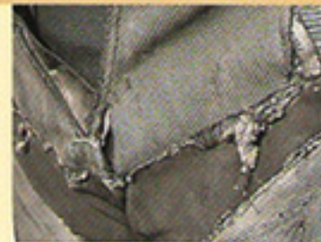
Die Nähte zwischen Leder und Textil sind nach 400 Metern durch
