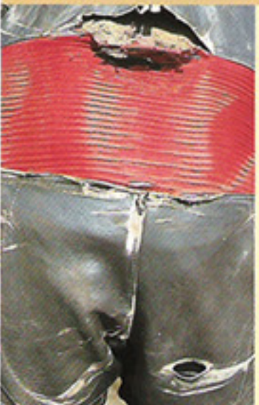
Hinter dem Riss am Rücken verbirgt sich ein Rückenprotektor mit abriebfestem Kevlarfilz
